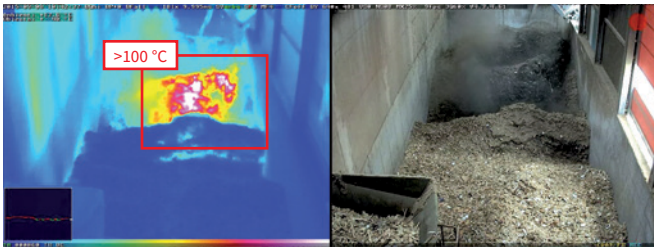
Thermal Radiometrie (TR): Automatischer Alarm bei Über- oder Unterschreiten von definierten Temperaturgrenzen
