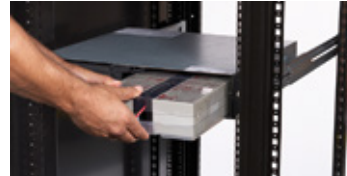
Die Batterien dieser Eaton 9130 sind „hot-swappable“
