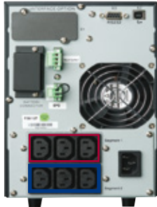
Diese Eaton 9130 USV ist mit zwei Lastsegmenten ausgestattet, beide mit drei 5-15 R Steckverbindungen
